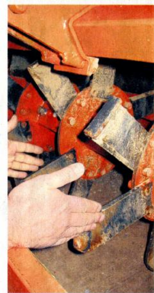
Zwei Maschinen zur Schlitzdrainage hat Diez entwickelt und patentieren lassen. Breite und Tiefe sind dabei unter anderem variabel einstellbar.
