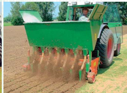
Drainschlitz bis 18 cm Tiefe mit Verfüllung. Reihenabstand ab 11 cm variabel je nach Anforderung.
